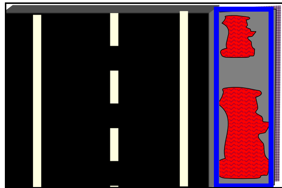
รูปที่ 8 น้ำไหลกัดเซาะคันทางชำรุดเสียหาย (ด้านคันทาง)
